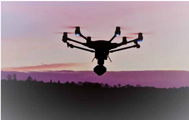
Ein Multikopter (Drohne mit mehreren Rotoren) steigt auf. Jeder der Rotoren verfügt über einen eigenen Antrieb. Dies sorgt für eine präzisere Steuerung und mehr Stabilität. Mit den noch relativ primitiven UAVs der ersten Jahre haben die heutigen Modelle nur noch wenig zu tun. Foto: Sven Löffler / pixelio.de
