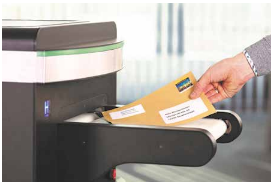
Eine der High-Tech-Lösungen für die technische Detektion von Brief- und Paketbomben: Der Millimeterwellenscanner T-Sense. Kleinere Unternehmen, die nicht zu solchen Optionen greifen wollen, sollten auf jeden Fall verdächtige Sendungen mit einem Metalldetektor überprüfen. Nachteil: Metalldetektoren sprechen auch auf Büro- und Heftklammern an. Foto: Hübner GmbH & Co. KG
